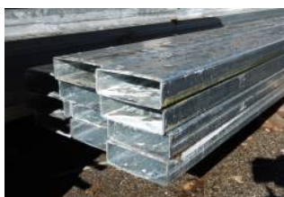
PARTICOLARE TUBOLARE RETTANGOLARE IN FERRO ZINCATO A CALDO
